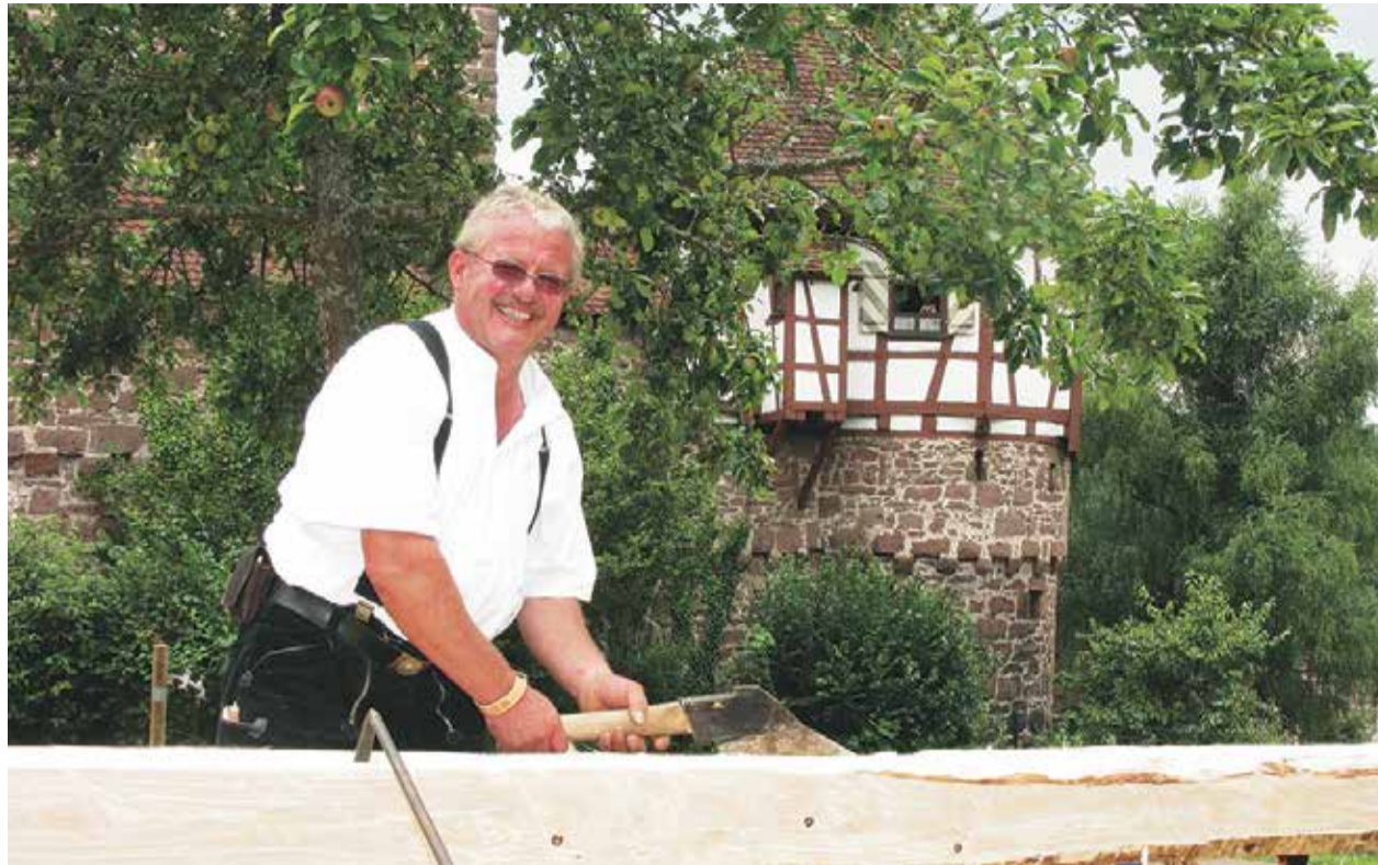
Mit dem Breitbeil in der Hand, führt Zimmermann Gerhard Gleiser aus Grömbach die harte und muskelstrapazierende Arbeit des Behauen eines Balkens vor, wie es früher üblich war, als es noch keine Maschinen gab.
